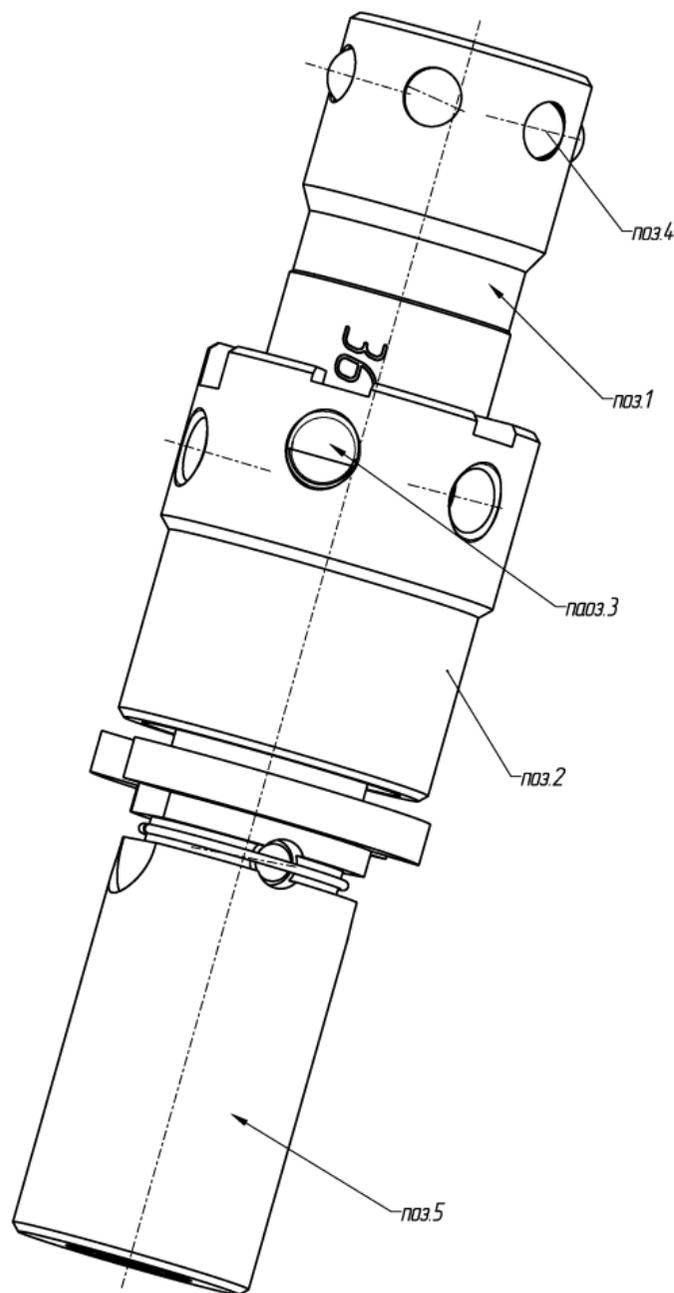
1. Раскатник предназначен для упрочнения стенок предварительно просверленных соединительных отверстий в железнодорожных рельсах.
